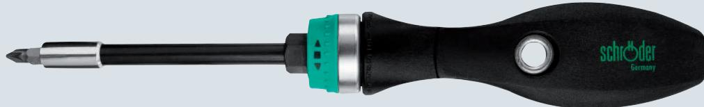
Die integrierte umschaltbare Mechanik lässt sich in drei Positionen verstehen. In der mittleren Position ist die Funktion mit einem handelsüblichen Schraubendreher zu vergleichen. Die beiden anderen Positionen sorgen für die gewünschte „Krarren“-Funktion. Die protorq Mechanik zeichnet sich hierbei durch minimale Rückstellwinkel und geringste Rückdrehkräfte aus.
